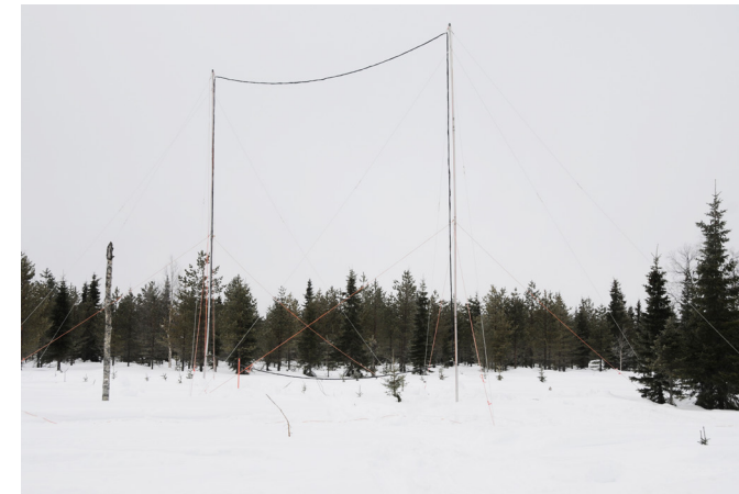
Iso VLF-antenni Kannuslehdossa Sodankylässä. Mastojen korkeus on 12 metriä ja antennisilmukan koko on 10 x 10 metriä. (Kuva: Jyrki Manninen)
